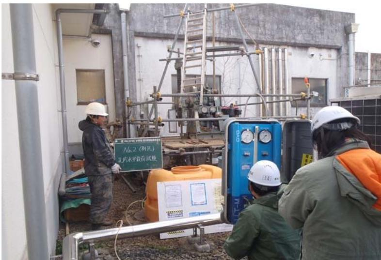
孔内水平載荷試験
