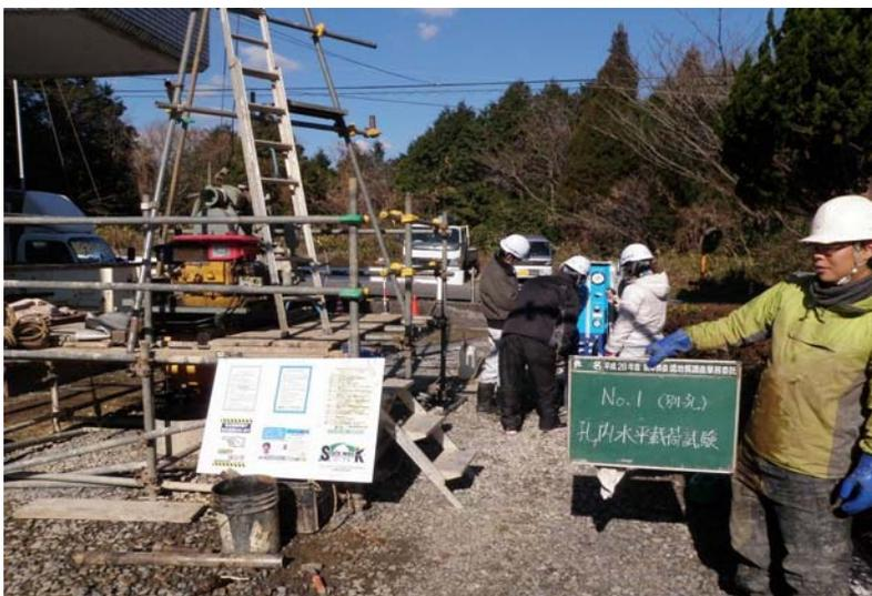
孔内水平載荷試験
